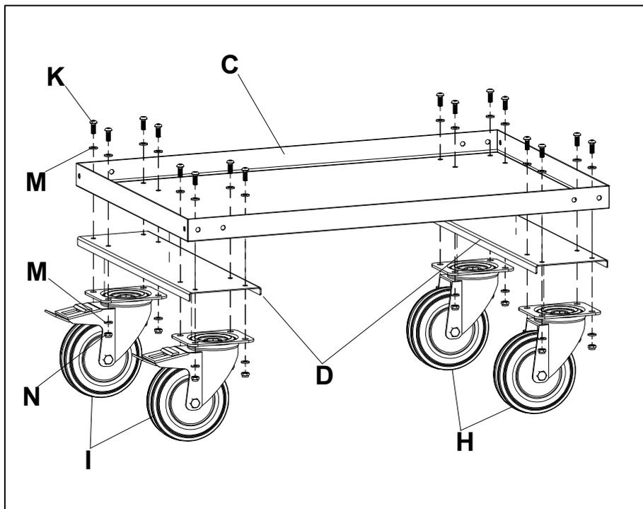
Установить на основание **С** и ложементы **Д** колёса поворотные **Н** и колёса поворотные с тормозом **И** при помощи винтов **К** (М6х16), шайб **М** и гаек самоконтрящихся **Н**.
