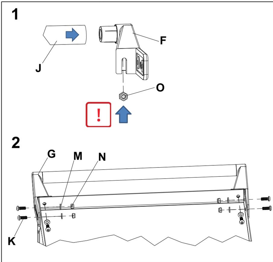
Вставить ручку левую **F** и ручку правую **G** в трубу **J**. Завести гайки **O** внутрь пластиковых ручек. Затем установить ручки на лоток при помощи винтов **K** (M6x16), шайб **M** и гаек **N**.
