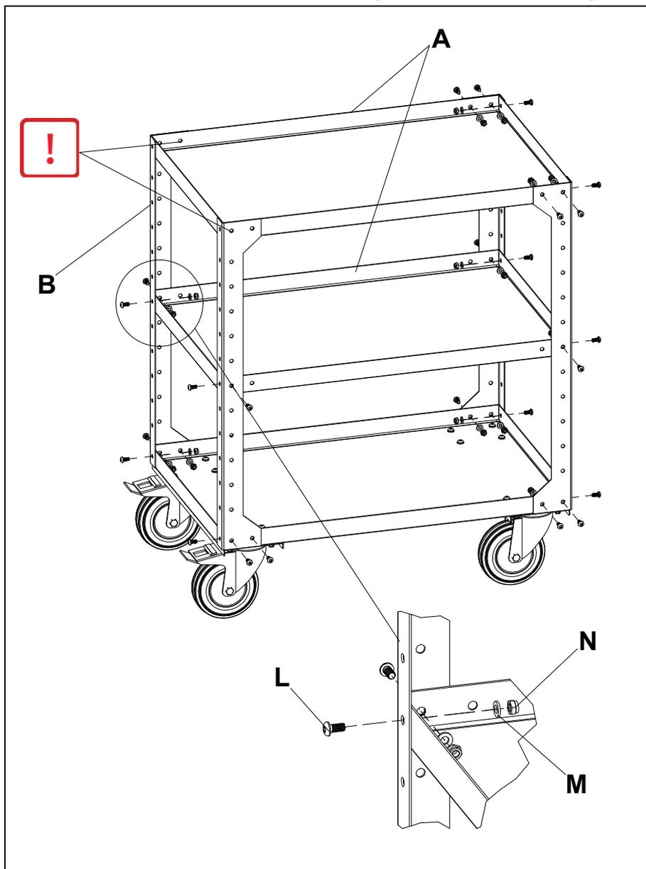
Установить на основание вертикальные направляющие **В**, а затем и полки **А** при помощи винтов **Л** (М6х12), шайб **М** и гаек самоконтрящихся **Н**.
